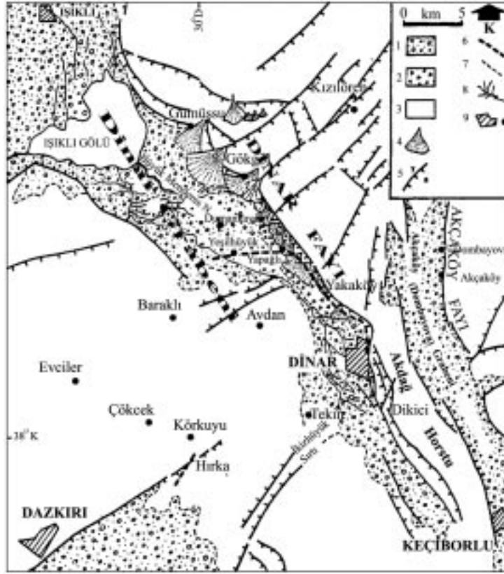
Şekil 1. Dinar ve çevresinin neotektonik haritası: 1)Pliyo-Kuvaterner yaşlı, gevşek alüvyon dolgusu, 2)talus, 3)temel kayaları, 4)alüvyon yelpazesi, 5)fay, 6)1995 depreminin yüzey kırığı, 7)alüvyon sınırı, 8)akarsular, 9)yerleşim alanları (TÜBİTAK, 1995'ten).
